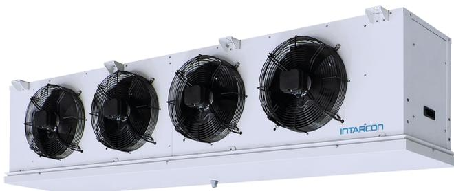
Unités d'évaporation de type cubique industriel, équipées de vannes de régulation, pour les chambres froides à haute, moyenne et basse température, construites en structure et en carrosserie d'acier galvanisé avec peinture polyester thermodurcissable.
