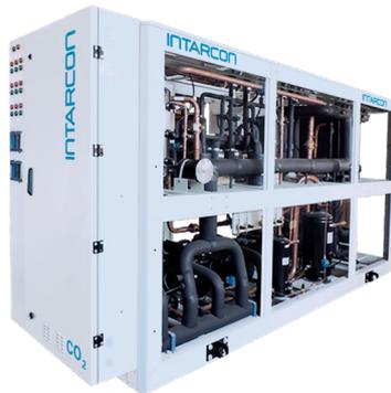
Rack de compresseurs de CO<sub>2</sub> de simple ou double aspiration en cycle transcritique, ou cycle subcritique condensat pour glycol ou réfrigérant. Les centrales ECO<sub>2</sub>Rack peuvent être construites en différentes combinaisons de groupes de 2 ou 3 compresseurs pour obtenir une capacité frigorifique totale de 50 jusqu'à 300 kW.
