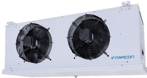
Unités d'évaporation de CO<sub>2</sub> du type cubique, équipées de vannes de régulation, pour les chambres froides à moyenne et basse température, construites en structure et en carrosserie d'acier galvanisé avec peinture polyester.
