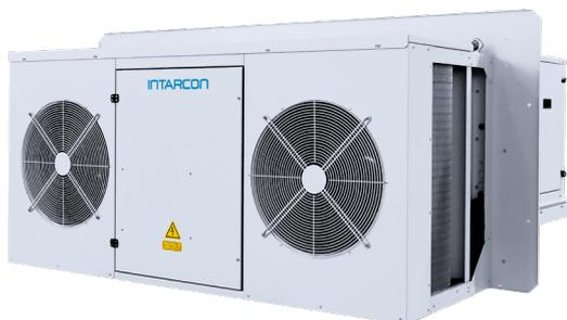
Unité monobloc industrielle de réfrigération, fabriquée en structure et carrosserie d'acier galvanisé avec peinture polyester thermodurcissable, conçue pour une installation murale en extérieure, même en cas d'intempérie, pour une chambre froide, avec accès facile de maintenance à travers des panneaux articulés.
