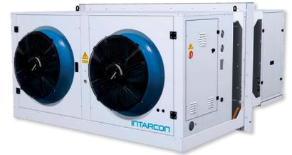
400 V-III-50 Hz | Haute température | Compresseur semi-hermétique | R-290
