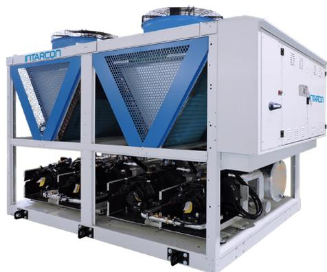
Refroidisseur de glycol, condensés par air, de grande puissance, pour des applications industriels. Se caractérisent par une construction très compacte, conçu pour extérieur, qui intègre les compresseurs semi-hermétiques, aérocondenseurs avec batteries en forme de V, échangeur à plaques et le tableau de contrôle.
