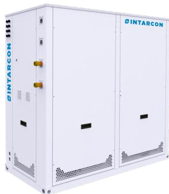
Groupe hydraulique pour le refroidissement de l'eau de réseau en circuit fermé, assemblé en carrosserie et structure en tôle d'acier galvanisée avec peinture polyester et tuyauterie en cuivre, pour installation à l'extérieur. Conçu pour fournir de l'eau à +1 °C à un boucle d'eau de recirculation et de consommation.
