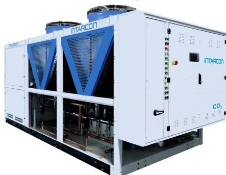
Centrales ECO<sub>2</sub>Watt de CO<sub>2</sub> de grande puissance, de simple ou double aspiration en cycle transcritique avec gas cooler incorporé, ou en cycle en cascade, adapté aux besoins de l'installation pour une capacité de refroidissement totale comprise entre 80 et 300 kW.
