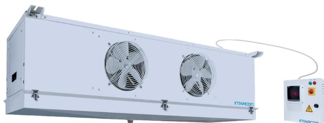
Les unités d'évaporation **waterloop**, avec compresseur intégré, sont équipements compacts pour une installation à l'intérieur des petites chambres froides, conçues avec réfrigérant naturel, R-290, et la condensation est faite grâce à une boucle d'eau.
