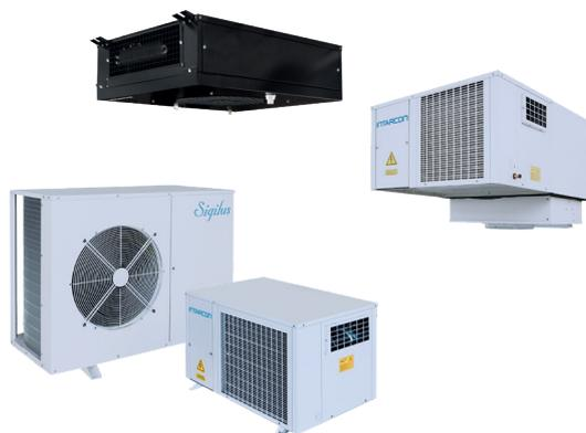
Systèmes split de réfrigération pour caves à vin, composé d'une unité de condensation axiale silencieuse ou centrifuge et une unité d'évaporation à double flux d'air avec fonction de chauffage, système d'humidification / déshumidification et pompe de condensats.
