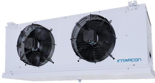
Unidades evaporadoras de CO<sub>2</sub> tipo cúbico, equipadas con válvulas de regulación, para cámaras frigoríficas a media y baja temperatura, construidas en estructura y carrocería de acero galvanizado con pintura poliéster.
