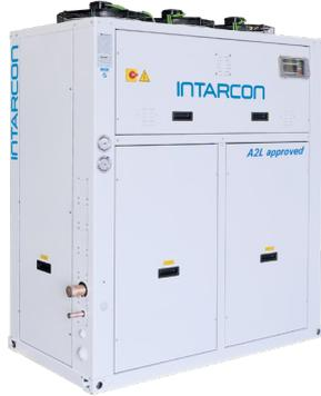
La gama de minicentrales intarCUBE A2L approved ha sido diseñada para aplicaciones de refrigeración comercial centralizada de media potencia, equipadas con compresores semiherméticos y diseñadas para trabajar indistintamente con refrigerante R-449A o con refrigerante ligeramente inflamable R-454C de bajo PCA (< 150).
