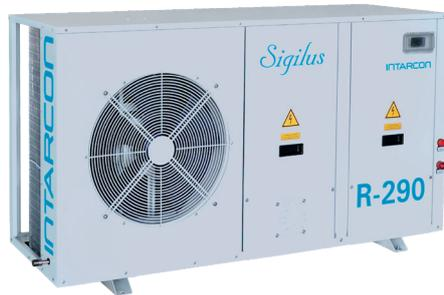
**Sigilus R-290** es la gama de plantas enfriadoras en construcción silenciosa condensada por aire para aplicaciones de refrigeración comercial, que utilizan una reducida carga de propano como refrigerante primario contenido en la planta, y agua, glicol o salmuera como refrigerante secundario para el transporte de frío.
