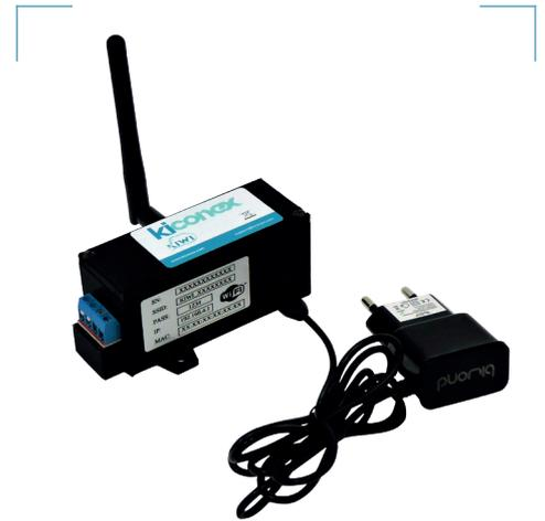
KiWi permite llegar a equipos que no estén físicamente conectados a cualquier bus RS485 de una instalación kiconex. Esto ayuda a realizar instalaciones de forma más rápida, así como da la oportunidad a que kiconex sea un sistema de fácil instalación en retrofit (rehabilitaciones o reformas).
