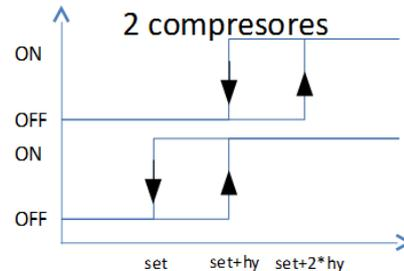
La regulación electrónica rota alternativamente el funcionamiento de los compresores para repartir el tiempo de trabajo.
