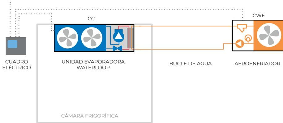
Ejemplo de instalación de un sistema waterloop R-290, donde hay distintos grupos frigoríficos distribuidos, además de cámaras de conservación en MT y congelación en BT, y 1 o varias unidades aeroenfriadoras en la cubierta para la evacuación del calor de condensación. Circuito hidráulico con retorno invertido.
