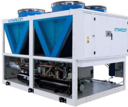
La gama intarWatt se compone de centrales frigoríficas de gran potencia condensadas por aire, para aplicaciones industriales. Se caracterizan por una construcción muy compacta diseñada para intemperie, que integra el conjunto de compresores semiherméticos, aerocondensadores con disposición de baterías en V, y el cuadro de control y potencia.
