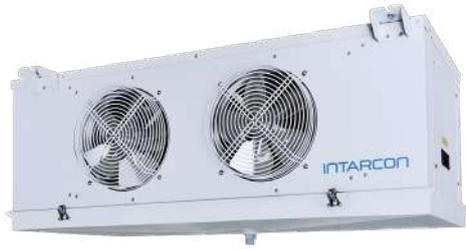
Unidades evaporadoras de tipo cúbico comercial, equipadas con válvulas de regulación y control electrónico, para cámaras frigoríficas de alta, media y baja temperatura, construidas en estructura de acero galvanizado y carrocería de aluminio con pintura poliéster.
