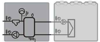
Opcional: bomba de primario de baja presión en grupo hidráulico, para conexión a una planta enfriadora.
