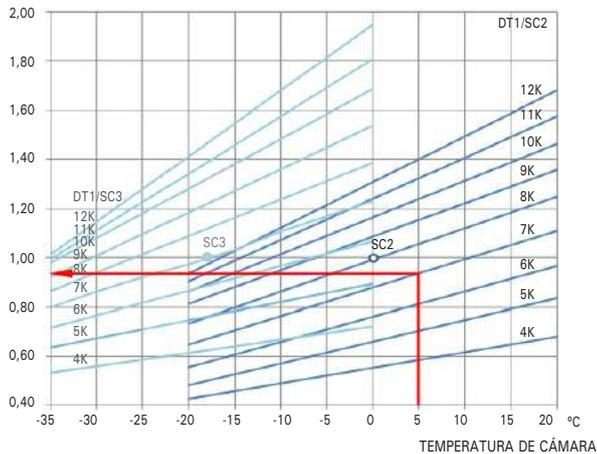
Para obtener la potencia frigorífica a otra temperatura de cámara y salto térmico, deberá utilizar el factor de corrección FT.
