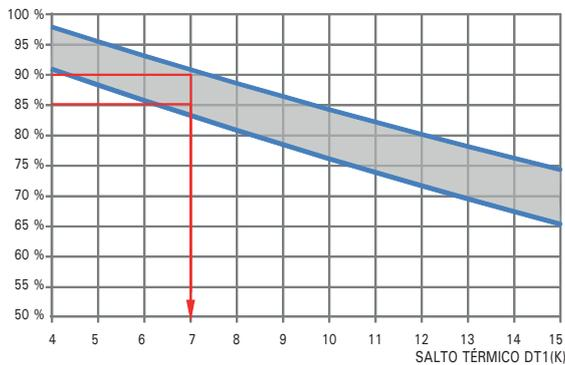
Se define el salto térmico DT1 como la diferencia entre la temperatura del aire a la entrada del evaporador y la temperatura de evaporación del refrigerante.
