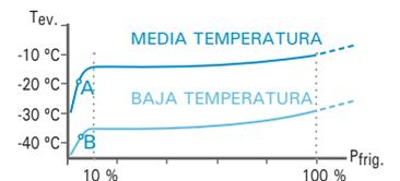
El sistema VRC puede regularse fácilmente para fijar una presión de evaporación mínima. El ajuste de fábrica proporciona las siguientes temperaturas mínimas de evaporación:
