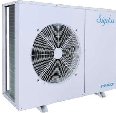
Unidades motocondensadoras compactas para refrigeración a media y baja temperatura, en construcción silenciosa con compresor hermético alternativo o scroll, con insonorización acústica, y motoventilador axial de baja velocidad.
