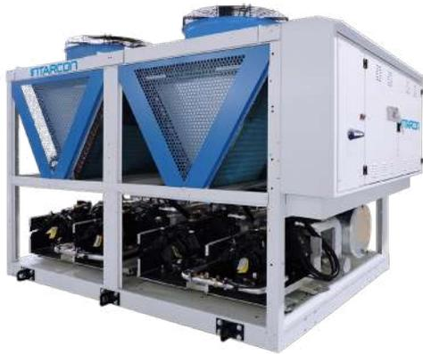
Plantas enfriadoras de glicol condensadas por aire, de gran potencia, para aplicaciones industriales. Se caracterizan por una construcción muy compacta, diseñada para intemperie, que integra los compresores semiherméticos, aerocondensadores con disposición de baterías en V, intercambiador de placas y el cuadro de control.
