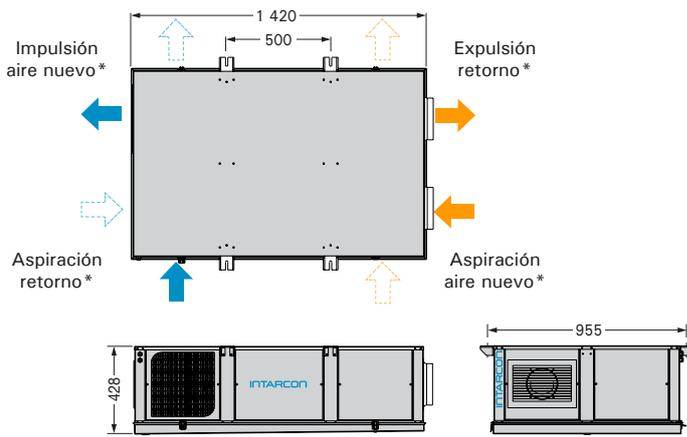
\* Lados de las conexiones de aire intercambiables.
