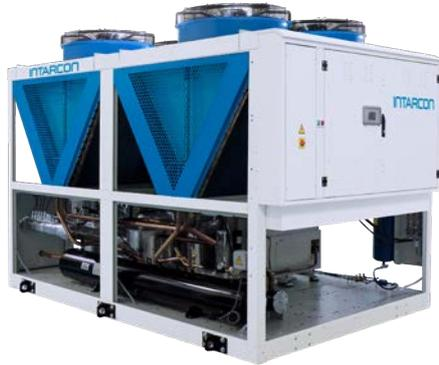
Die Reihe intarWatt besteht aus luftgekühlten Hochleistungs-Kühlanlagen für industrielle Anwendungen. Sie zeichnen sich durch ihre sehr kompakte Bauweise aus und sind für die Außeninstallation konzipiert, es sind halbhermetische Verdichter, Luftkondensatoren mit Batterien in V-Anordnung und integrierten Steuer- und Leistungs-Schaltschränken.
