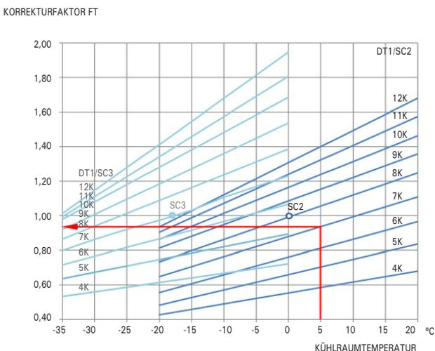
Für das Erreichen der Kühlleistung bei einer anderen Kühlraumtemperatur und Temperatursprung müssen Sie den Korrekturfaktor FT verwenden.
