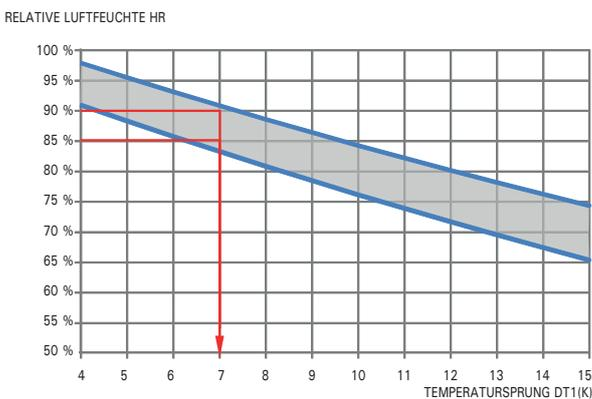
Der Temperatursprung DT1 wird als Differenz zwischen der Lufttemperatur am Eingang des Verdampfers und der Verdampfungstemperatur des Kältemittels definiert.
