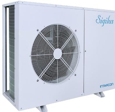
Monoblock-Kondensatoren zur Kühlung bei mittlerer und niedriger Temperatur in geräuscharmer Konstruktion mit hermetischem Kolbenverdichter und Schalldämmung sowie langsam laufendem Axial-Lüfer.
