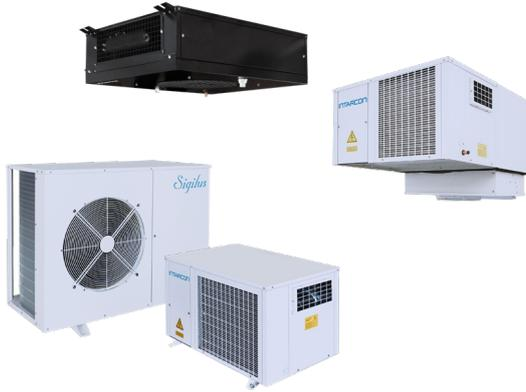
Geräte für die Klimatisierung von Weinkellern in Split-Bauweise mit geräuscharm oder Radial-Kondensator und Verdampfer für die Deckenmontage mit doppelter Luftströmung, Heizwiderständen, System zur Befeuchtung/Entfeuchtung, Kondensatpumpe und in Monoblock-Bauweise für die Decke mit Axial- oder Radial-Kondensation.
