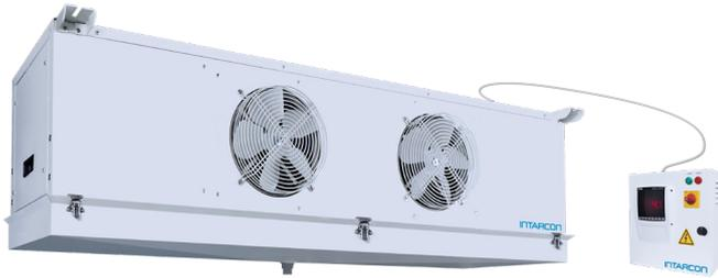
Die Verdampfer **Waterloop** mit Verdichter sind Monoblock-Kühlanlagen für den Einbau in kleine Kühlräume, entworfen mit natürlichem Kältemittel R-290 und Kondensation im Wasserkreislauf.
