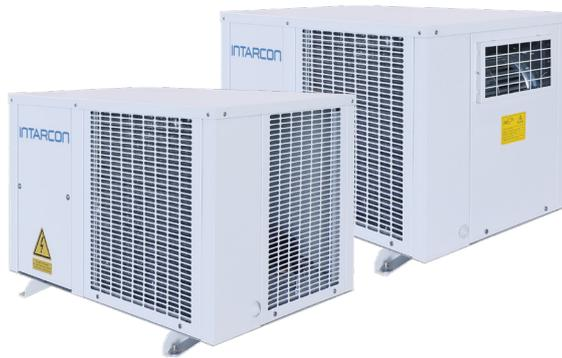
Monoblock-Kondensatoren mit Direktantrieb zur Kühlung bei mittlerer und niedriger Temperatur in horizontaler Konstruktion mit hermetischem Kolbenverdichter und langsamlaufenden Axial- oder Radial-Motorventilator.
