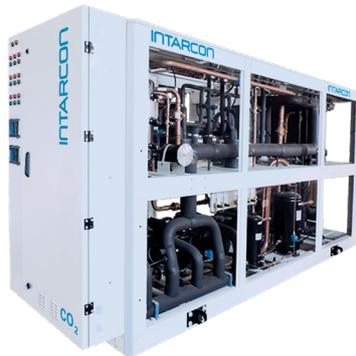
Rack de compresores de CO<sub>2</sub> de simple o doble aspiración en ciclo transcrito, o en ciclo subcrítico condensado por glicol o refrigerante. Las centrales ECO<sub>2</sub>Rack pueden construirse en distintas combinaciones de compresores para ofrecer una potencia frigorífica total de 50 hasta 300 kW.
