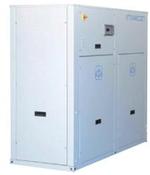
Las tricentrales INTARCON son centrales de producción frigorífica condensadas por aire con tres líneas de aspiración de refrigeración a tres niveles de presión, diseñadas para dar servicio a unidades evaporadoras de expansión directa de refrigeración a temperaturas positiva y negativa y climatización a alta temperatura, incorporando además la recuperación de calor para calefacción y producción de agua caliente sanitaria.
